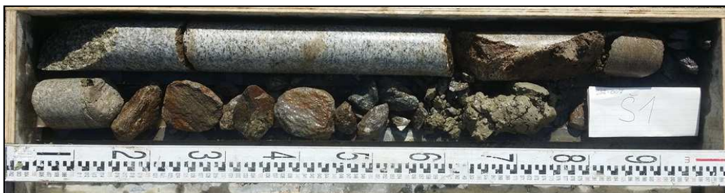
Obr. č. 2 – Šikmý jádrový vrt Š1 do podzákladí – opěra Polná
