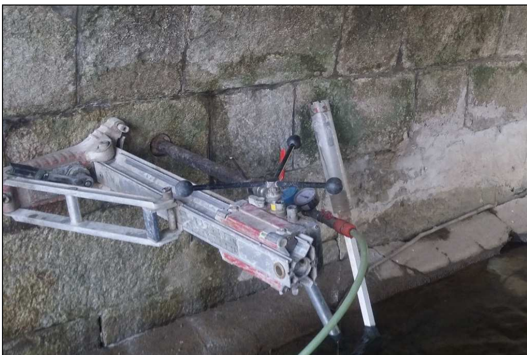
Obr. č. 4 – Pohled na provádění vodní tlakové zkoušky ve vodorovném vrtu do opěry Žďár n. S.
