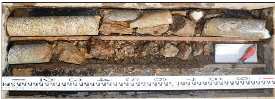
Obr. č. 1 – Vodorovný jádrový vrt V1 – opěra Žďár n. S.
